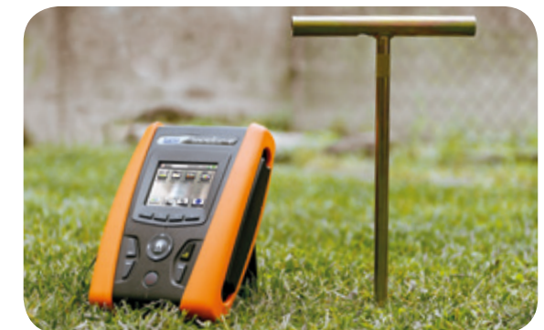
Misura di resistenza di terra con metodo Voltamperometrico.
