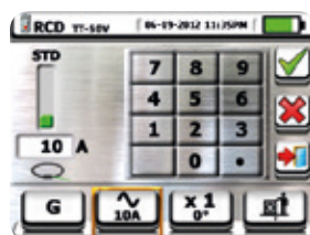
Selezione corrente di intervento RCD con toroide separato
