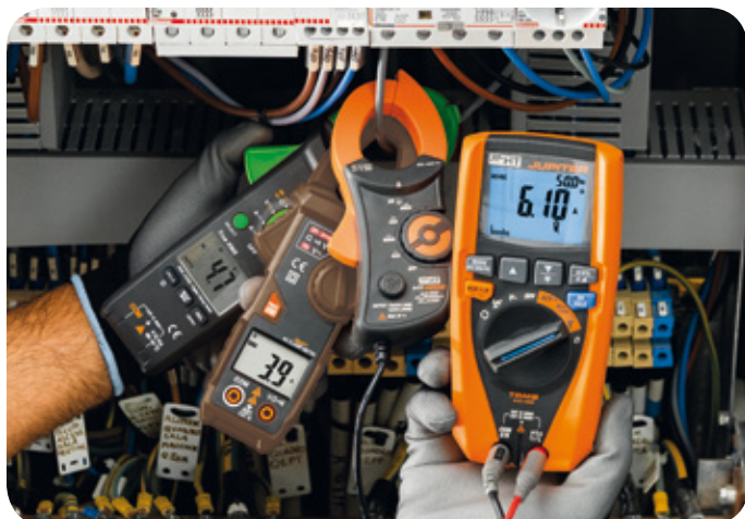
Confronto fra pinze: 3.9A: pinza a valore medio - 4.7A: pinza TRMS 6.1A: lettura corretta AC+DC TRMS.
