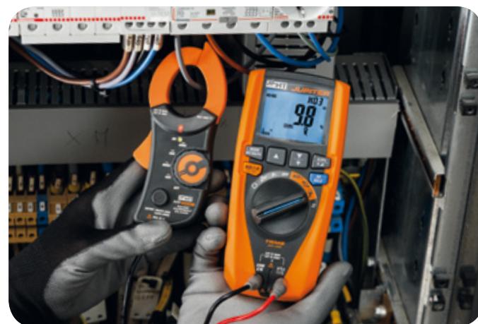
Misura di armoniche di corrente.
