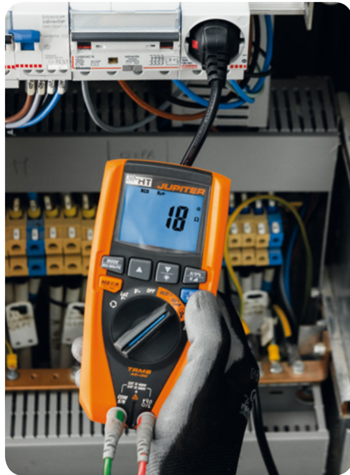
Misura resistenza globale di terra .
