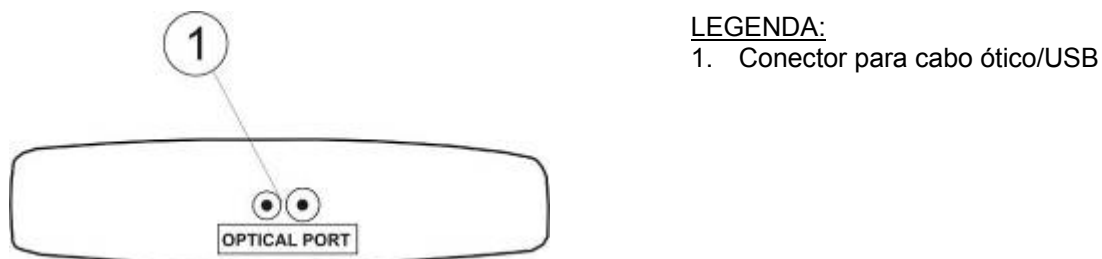
Fig. 2: Descrição dos terminais de entrada do instrumento
