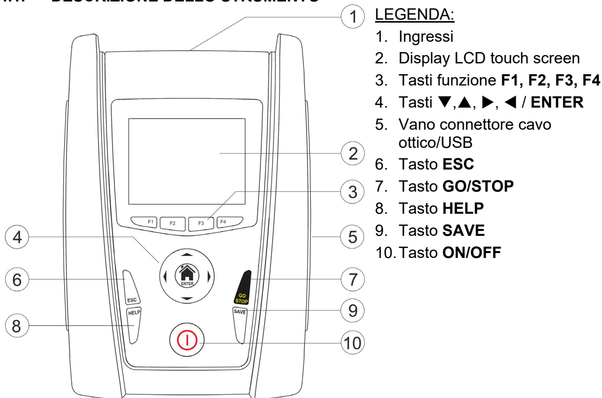
Fig. 1: Descrizione parte frontale dello strumento
