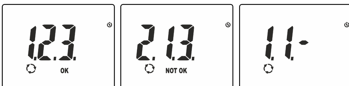
Fig. 14: Esiti del test di sequenza e concordanza delle fasi
