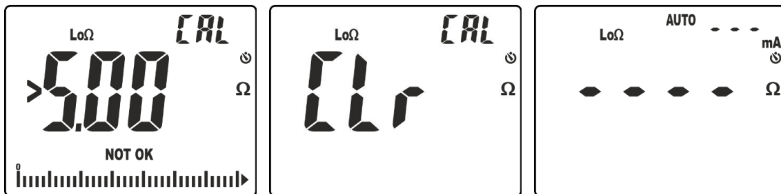
Fig. 34: Risultati azzeramento non eseguito correttamente
