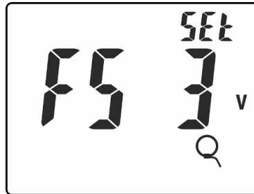
Fig. 5: Impostazione fondo scala pinza flessibile
