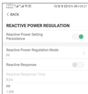
Figura 7-18 Regolazione della potenza reattiva
