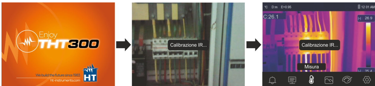
Fig. 4: Sequenza di accensione dello strumento
