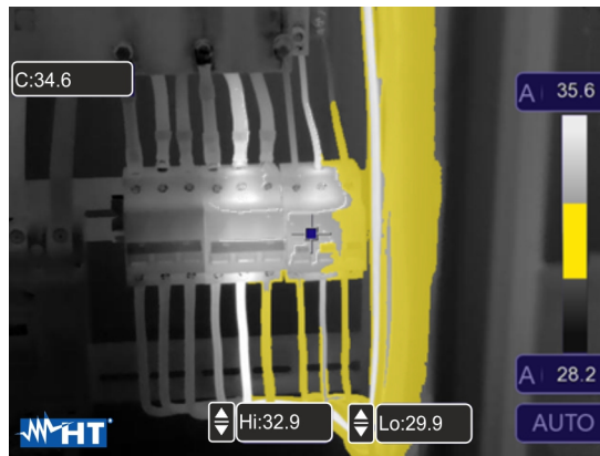
Fig. 39: Selezione isoterma Allarme intervallo Temp.
