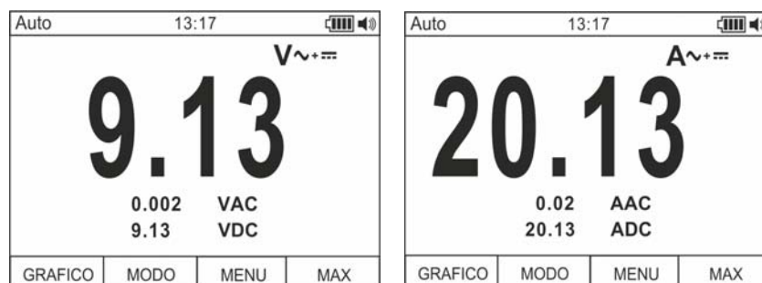
Fig. 3: Descrizione misura tensione e corrente AC+DC
