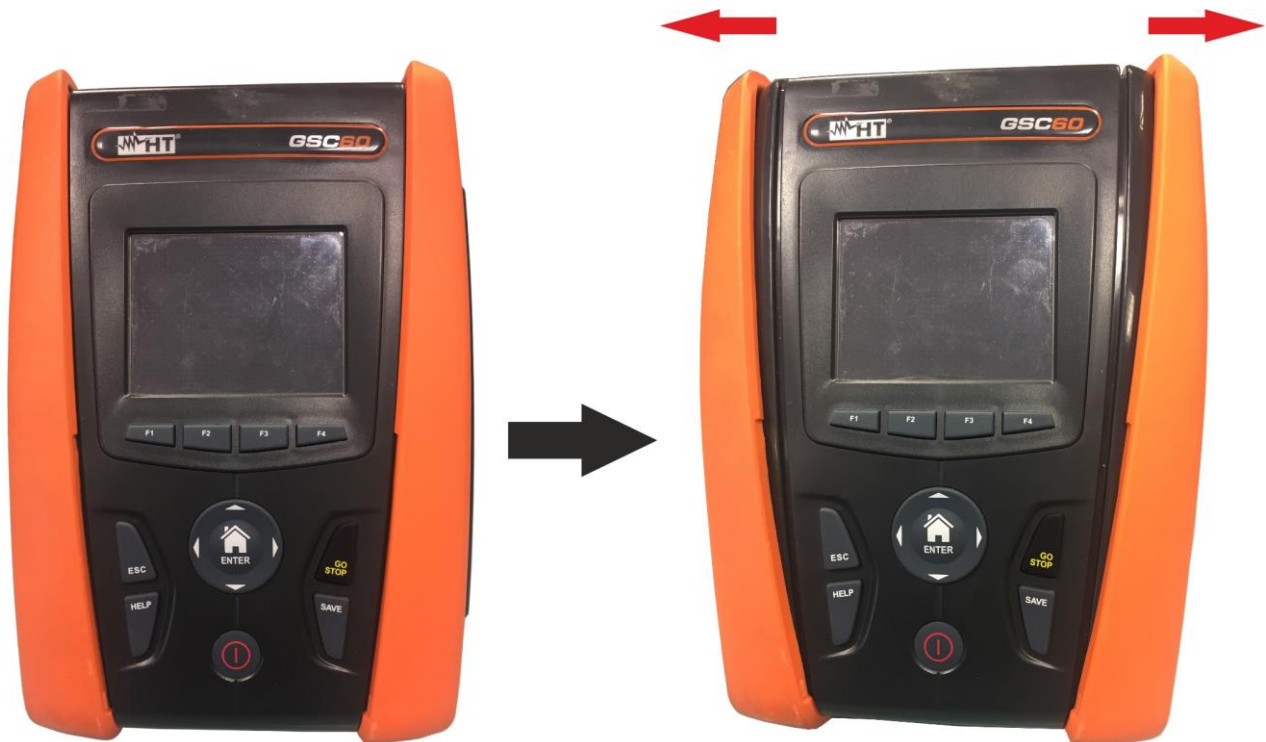
Fig. 46: Smontaggio semigusci laterali
