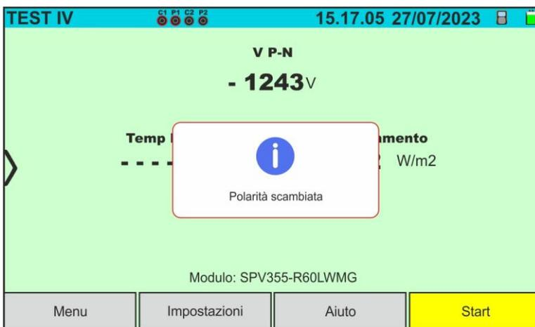
Qualora lo strumento rilevi ai terminali P-N della stringa una tensione  $< -0.5VDC$  non esegue la prova e visualizza il messaggio riportato nella videata a lato. Controllare i collegamenti dei poli della stringa
