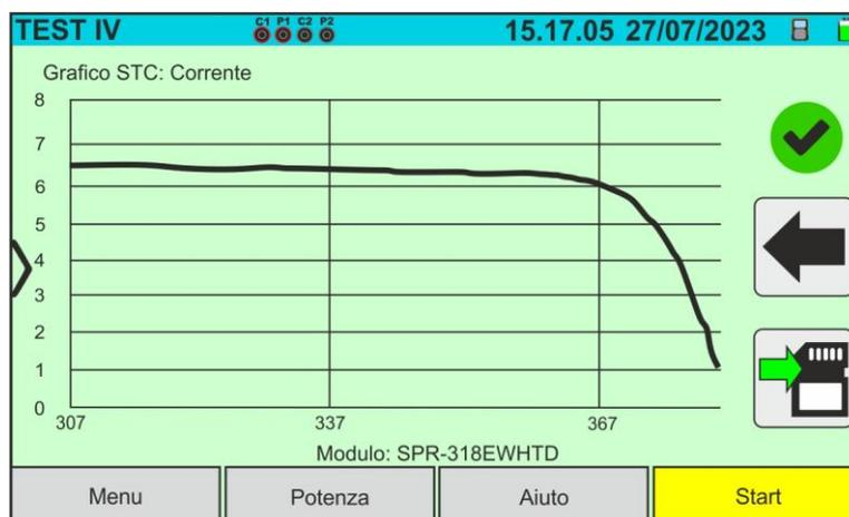
Fig. 39: Esempio di risultato misura curva I-V – Curva STC
