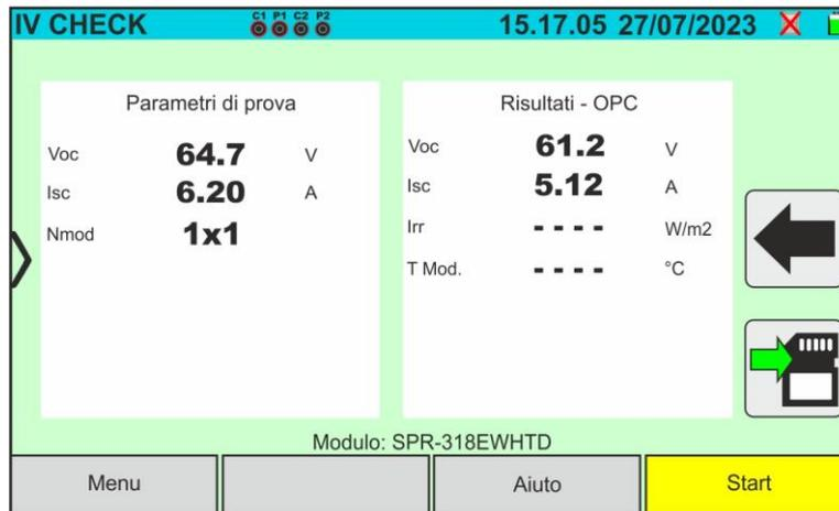
Fig. 60: Risultato misura test IVCK @OPC con registrazione sincrona
