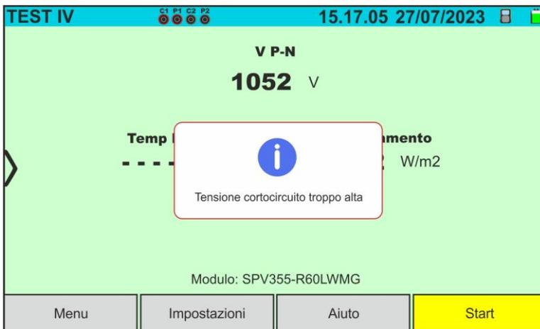
Se, durante l'esecuzione di una misura I-V o IVCK il valore della tensione misurata è maggiore del 12% $V_{oc}$ , lo strumento non esegue la misura e mostra il messaggio della videata a lato. Controllare il circuito in misura e ripetere la prova
