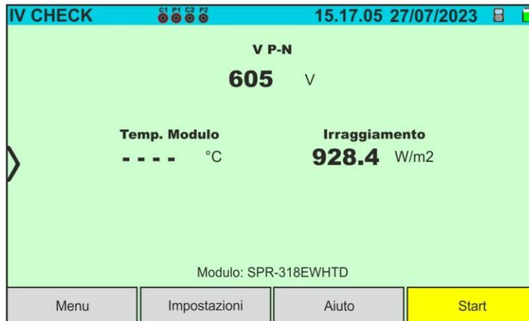
Fig. 53: Videata iniziale test IVCK senza unità remota su moduli Monofacciali
