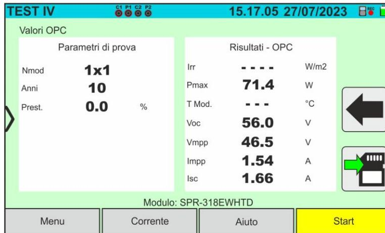
Fig. 43: Risultato misura curva I-V @OPC con registrazione sincrona
