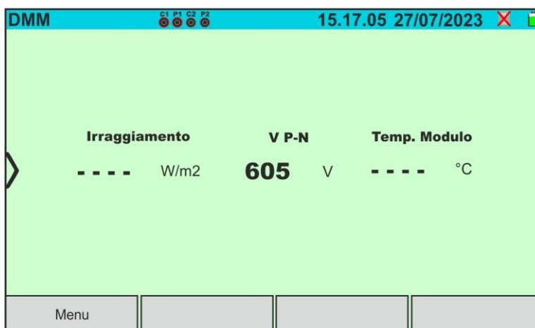
Fig. 14: Videata di misura funzione DMM (SOLAR03 scollegato)
