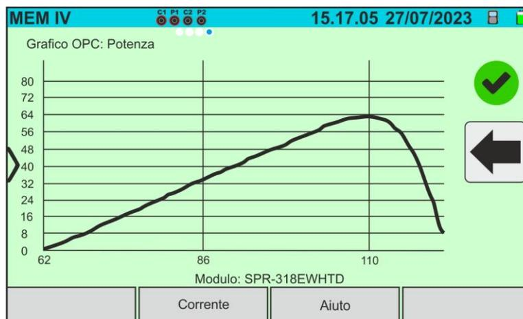
Fig. 77: Richiamo dei risultati misura curva I-V – Curva potenza @OPC
