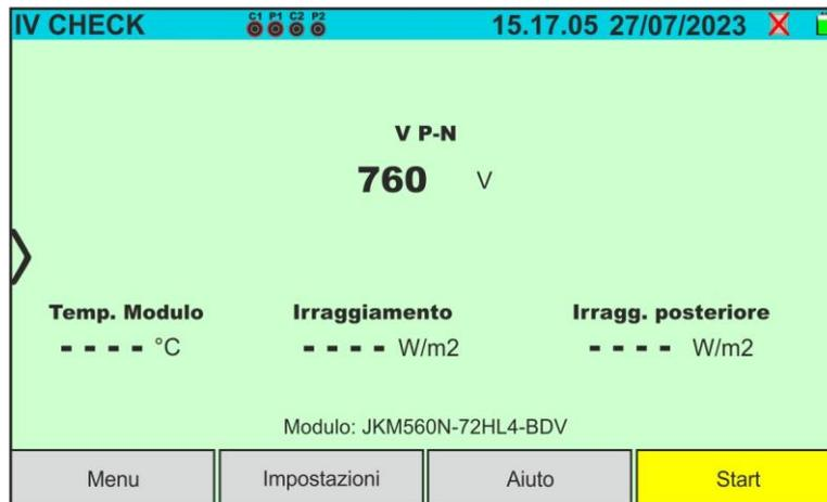
Fig. 47: Videata iniziale test IVCK senza unità remota su moduli Bifacciali
