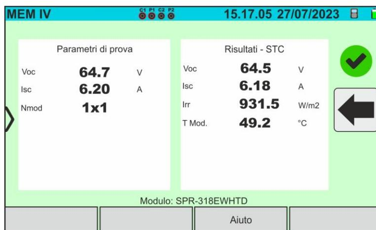
Fig. 78: Richiamo dei risultati test IVCK @STC
