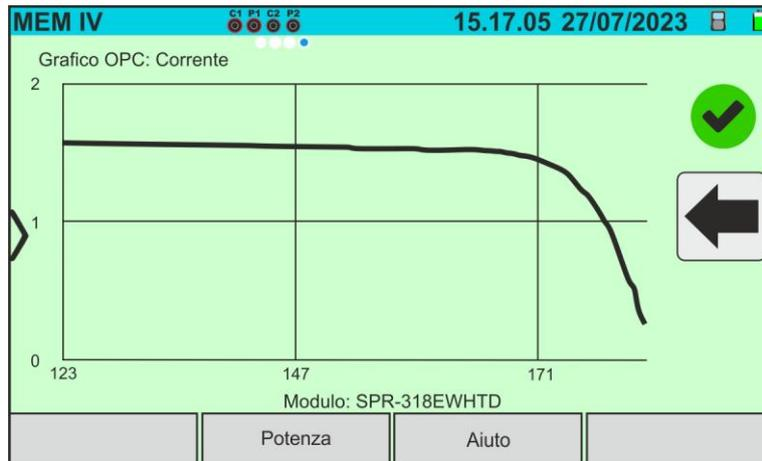
Fig. 76: Richiamo dei risultati misura curva I-V – Curva corrente @OPC
