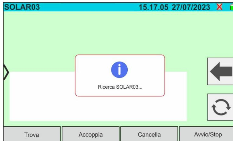
Fig. 16: Accoppiamento unità remota SOLAR03 – Passo 2
