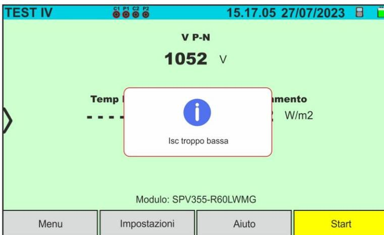
Qualora lo strumento rilevi una corrente di cortocircuito **Isc minore di una soglia limite** non esegue la prova e mostra il messaggio riportato nella videata a lato. Controllare le connessioni dello strumento, la funzionalità del modulo/stringa, le impostazioni del modulo e il numero dei moduli
