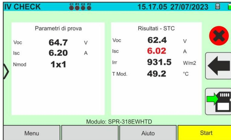
Fig. 59: Esempio di risultato negativo test IVCK – Valori STC
