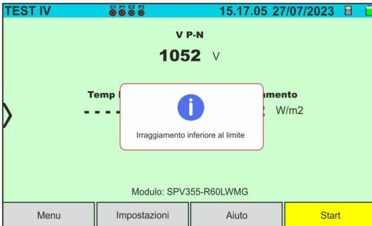
Qualora lo strumento, con unità remota attiva e connessa (anche in registrazione) rilevi un valore di irraggiamento inferiore alla soglia limite (vedere § 5.2) blocca la prova e ritorna alla videata principale. Verificare il valore della soglia ed eseguire i test in altro momento della giornata con irraggiamento stabile
