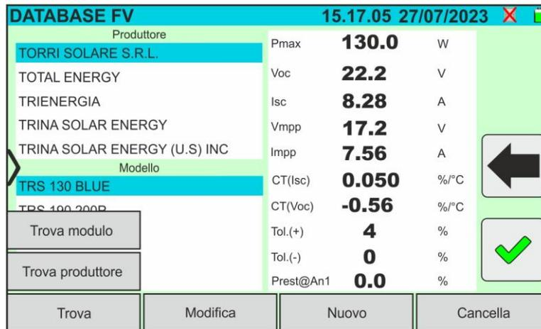
Fig. 29: Ricerca modulo all'interno del database
