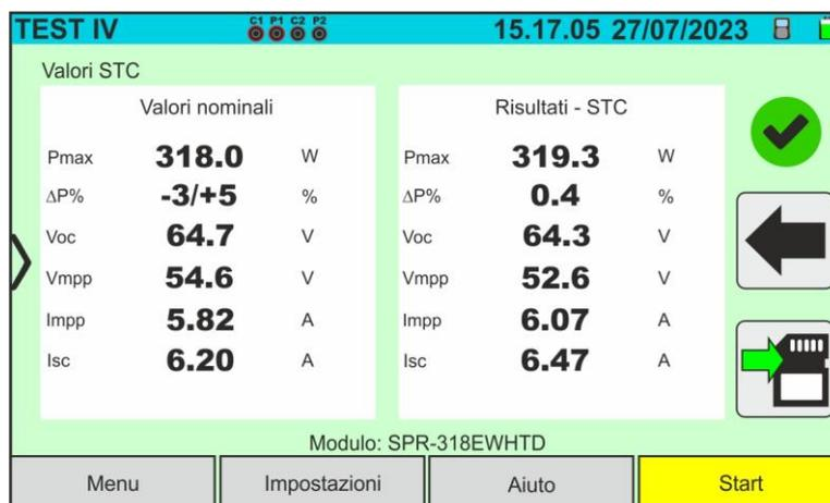
Fig. 37: Esempio di risultato misura curva I-V – Valori STC
