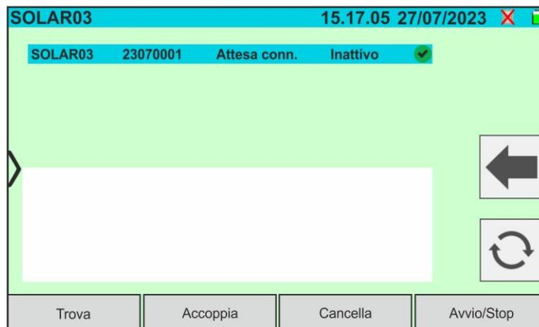
Fig. 17: Accoppiamento unità remota SOLAR03 – Passo 3
