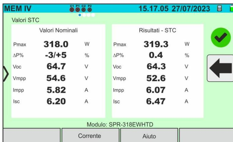
Fig. 72: Richiamo dei risultati misura curva I-V – Valori @STC
