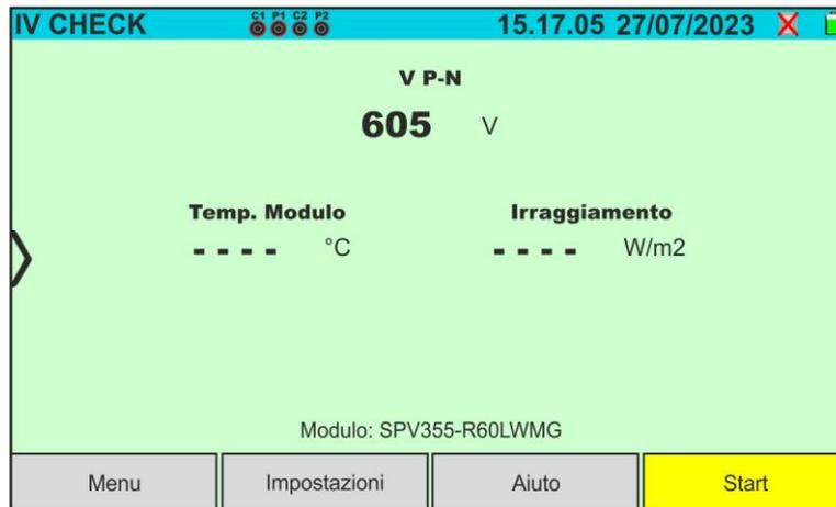
Fig. 46: Videata iniziale test IVCK senza unità remota su moduli Monofacciali
