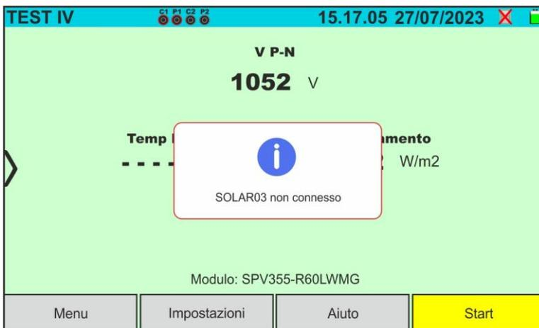
Nel caso in cui l'unità remota SOLAR03 sia attivo ma **non connesso e non in registrazione** lo strumento non esegue la prova e visualizza il messaggio riportato nella videata a lato. Eseguire la connessione dell'unità remota SOLAR03
