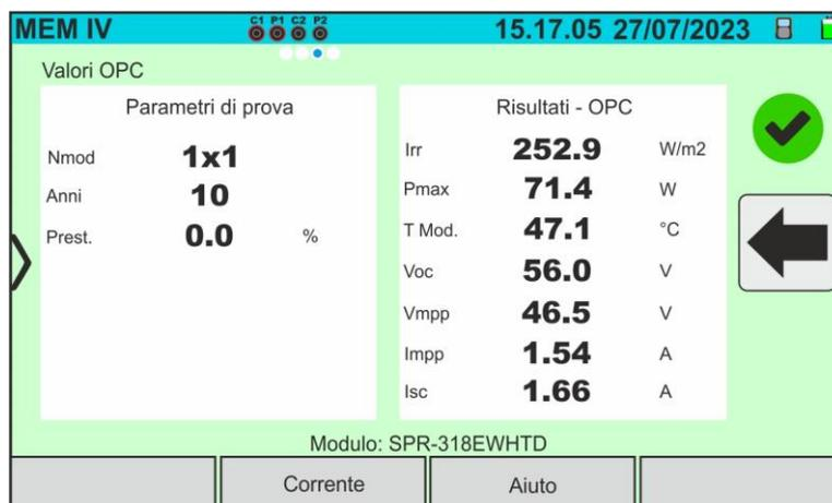
Fig. 75: Richiamo dei risultati misura curva I-V – Valori @OTC
