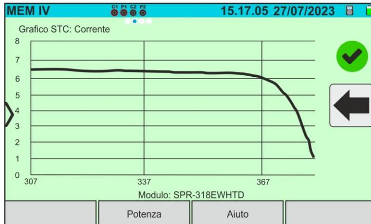
Fig. 73: Richiamo dei risultati misura curva I-V – Curva corrente @STC
