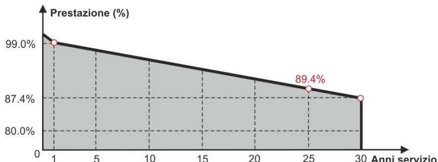
**Fig. 23:** Esempio di curva Anni/Prestazioni di un modulo FV
