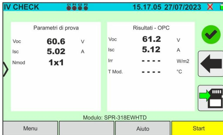
Fig. 50: Esempio di risultato positivo test IVCK – Valori OPC
