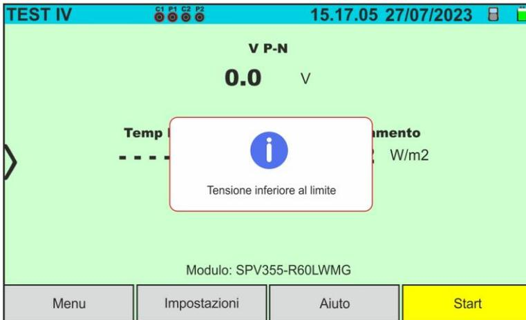
Qualora lo strumento rilevi ai terminali P-N della stringa una tensione  $-0.5V \leq V_{PN} \leq 15VDC$  non esegue la prova e visualizza il messaggio riportato nella videata a lato. Controllare la tensione sulla stringa
