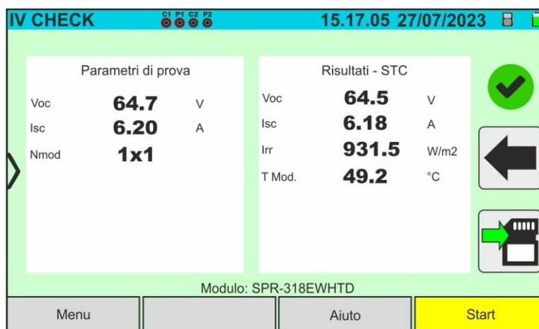
Fig. 58: Esempio di risultato positivo test IVCK – Valori STC
