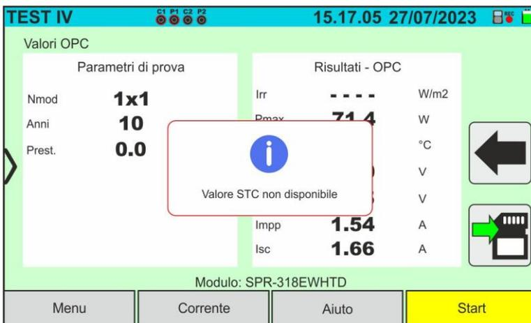
Se, durante l'esecuzione di una misura I-V o IVCK, lo strumento non riesce a determinare i valori @STC mostra il messaggio della videata a lato. Verificare di avere un irraggiamento stabile, oltre al corretto superamento della soglia minima e di aver eseguito la misura in accordo alle indicazioni dall'accessorio M304 (vedere § 6.4.2 – punto 10). Ripetere eventualmente le misure in altri momenti della giornata
