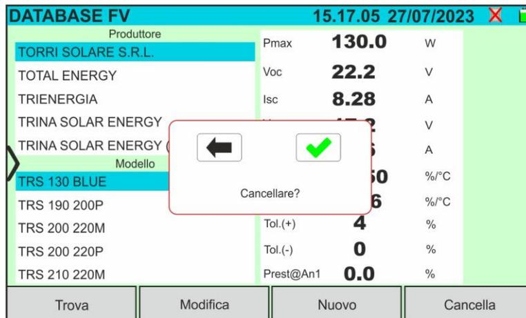
Fig. 32: Cancellazione di un modulo FV
