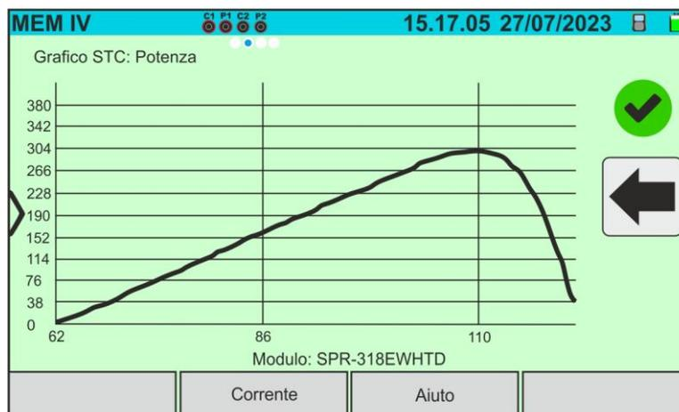
Fig. 74: Richiamo dei risultati misura curva I-V – Curva potenza @STC
