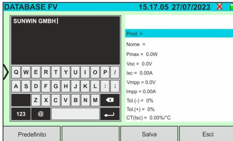
Fig. 25: Creazione nuovo modulo FV – Passo 1
