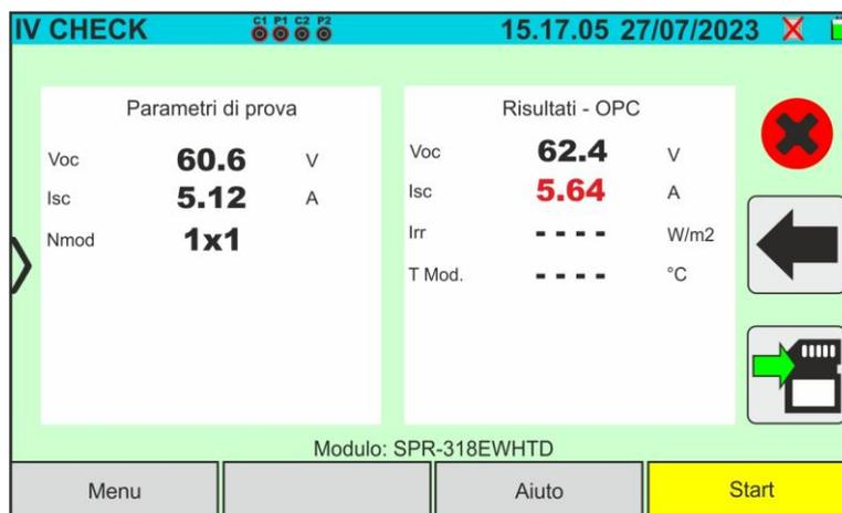
Fig. 51: Esempio di risultato negativo test IVCK – Valori OPC
