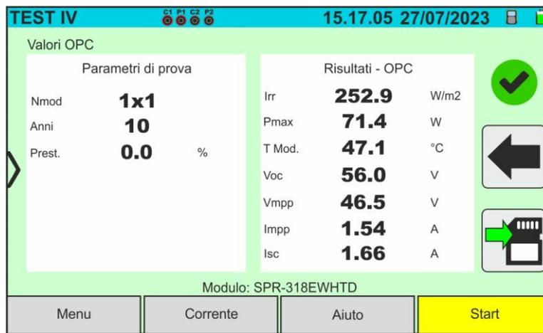
Fig. 38: Esempio di risultato misura curva I-V – Valori OPC
