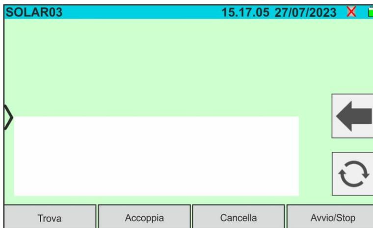
Fig. 15: Accoppiamento unità remota SOLAR03 – Passo 1
