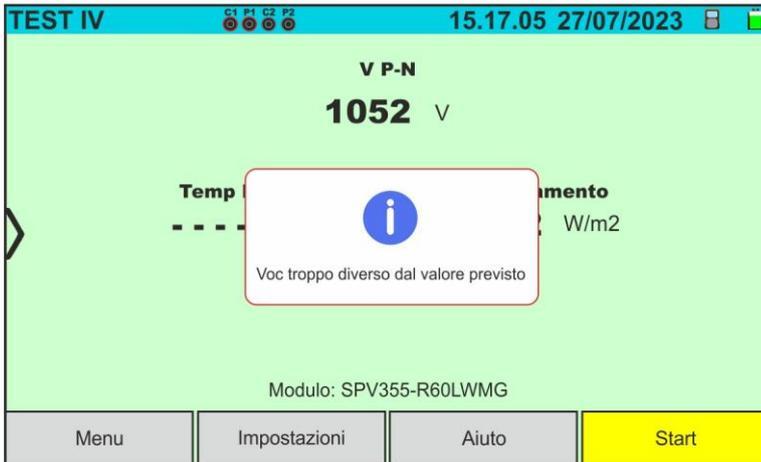
Se, durante l'esecuzione di una misura I-V o IVCK il valore della tensione a vuoto ( $V_{oc}$ ) è molto diverso da quello definito nel database del modulo, lo strumento non esegue la misura e mostra il messaggio della videata a lato. Controllare i valori del parametro  $V_{oc}$ ,  $CT(V_{oc})$  all'interno del database e il numero di moduli impostato nella misura
