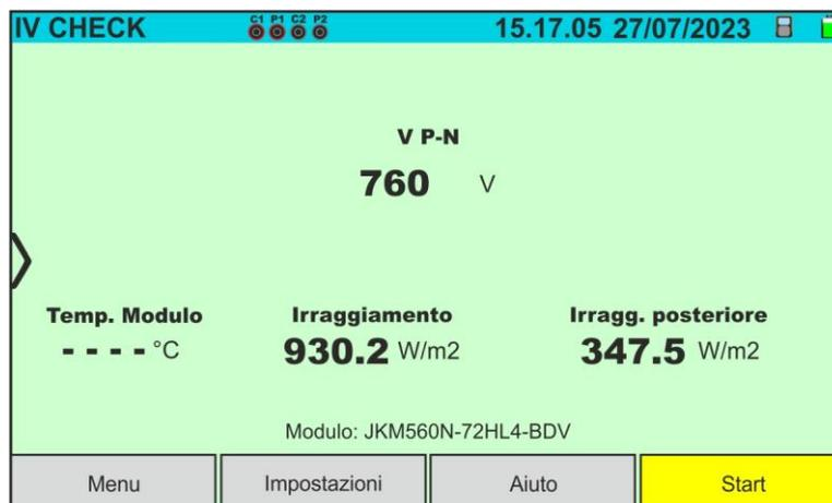
Fig. 54: Videata iniziale test IVCK senza unità remota su moduli Bifacciali
