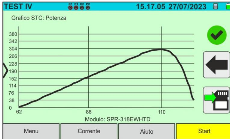
Fig. 40: Esempio di risultato misura Potenza – Curva STC
