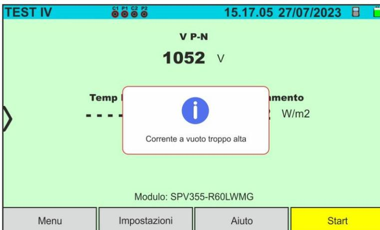
Nella misura di curva I-V, se la corrente rilevata in corrispondenza del punto di Voc (situazione a vuoto) è maggiore di 0.2A, lo strumento non esegue la prova e mostra il messaggio riportato nella videata a lato.. Controllare il circuito in misura e ripetere la prova.
