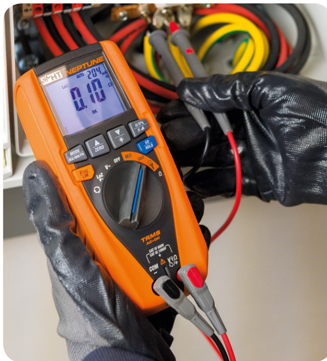
Continuità dei conduttori di protezione con 200mA.
