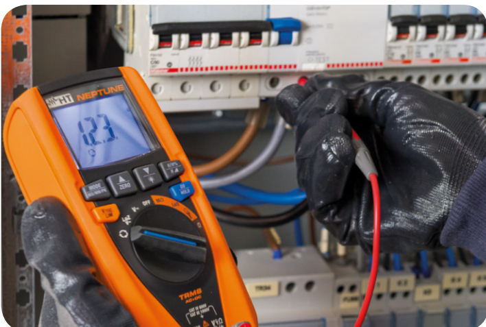
Misura del senso ciclico delle fasi con un puntale.
