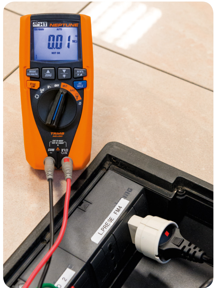
Misura Resistenza di Isolamento (Adattatore Schuko C2065 opzionale).
